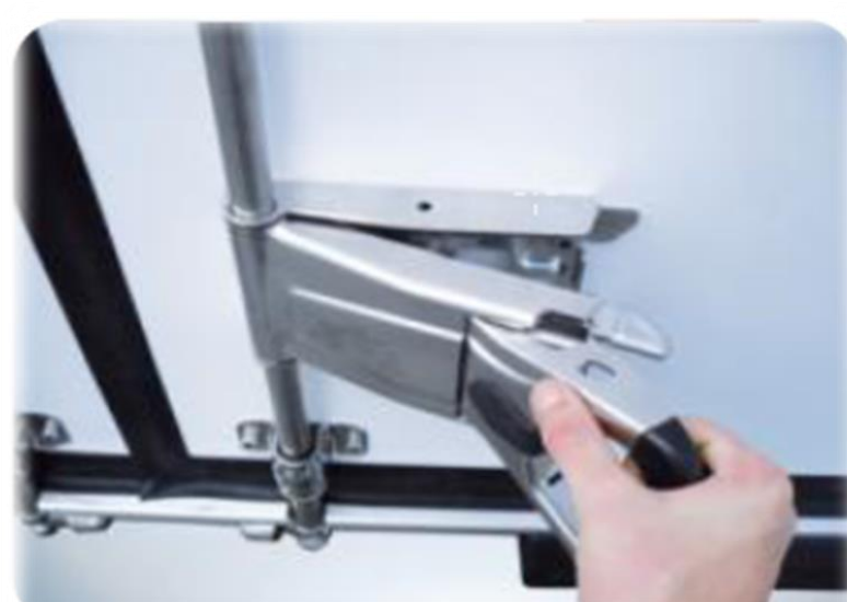
Нова ручка "Easy Handle" з одним рухом, на задніх дверях
